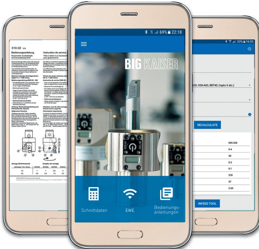
3 Nach Eingabe von Parametern wie Bohrungsdurchmesser, Werkstoff oder Auskraglänge gibt die App von BIG Kaiser unter anderem an, welches Tool mit welcher Platte ausgestattet werden soll und welche Schnittdaten einzustellen sind © BIG Kaiser
